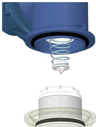
Seulement pour le modèle Pico, il est nécessaire de séparer le support spécial dans la partie inférieure de l'élément filtrant usé et de l'insérer sur le nouvel élément.
