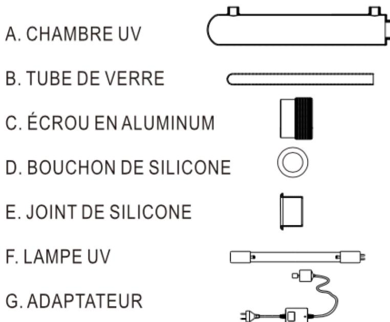
Étape 1. Placez le bouchon de silicone ou le joint de silicone (pièce D ou E) à l'extrémité ouverte du tube de verre (pièce B). Voir schéma 1.
