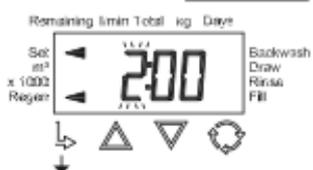
Heure de la régénération, Heure - Réglez l'heure de la régénération en utilisant UP ou DOWN. L'heure par défaut est 2:00 a.m. Cet affichage indiquera "on 0" si "on 0" est sélectionné à l'étape 3S. Appuyez sur NEXT pour passer à l'étape 61. Appuyez sur REGEN pour revenir à l'étape précédente.
