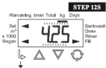
**RETURN TO NORMAL MODE** ÉTAPE 12S - Réglez la durée du remplissage de 0,05-90,0 kg de NaCl ou OFF en utilisant UP ou DOWN. Cet affichage n'apparaîtra pas si l'étape 2S est réglée sur FLT1. Appuyez sur NEXT pour quitter la configuration du système OEM. Appuyez sur REGEN pour revenir à l'étape précédente.
