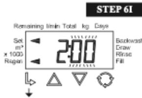
Heure de la régénération, minutes - Réglez l'heure (minutes) de la régénération en utilisant UP ou DOWN. L'heure par défaut est 2:00 a.m. Cet affichage n'apparaîtra pas si "on 0" est sélectionné à l'étape 3S. Appuyez sur NEXT pour passer à l'étape 7I. Appuyez sur REGEN pour revenir à l'étape précédente.
