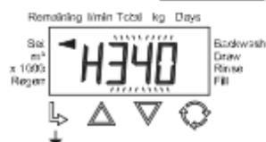
Dureté de l'eau d'entrée (PPM) - Réglez la quantité de dureté de l'eau d'entrée en utilisant UP ou DOWN. Appuyez sur NEXT pour passer à l'étape 31. Appuyez sur REGEN pour quitter les paramètres de l'installateur OEM. Cet écran ne s'affiche que lorsque "RES" est sélectionné à l'étape 3S.
