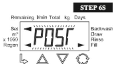
**ÉTAPE 6S :** - Type de remplissage - Utilisez UP ou DOWN pour sélectionner POST ou PRE. Cet affichage n'apparaît que si l'étape 2S est réglée sur SOFT. Appuyez sur NEXT pour passer à l'étape 7S. Appuyez sur REGEN pour revenir à l'étape précédente.
