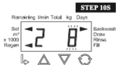
STEP 10S : - Réglez la durée du second lavage à contre-courant de 1 à 95 minutes ou OFF en utilisant UP ou DOWN. Cet affichage n'apparaîtra pas si l'étape 2S est réglée sur FLT1. Appuyez sur NEXT pour passer à l'étape 11S. Appuyez sur REGEN pour revenir à l'étape précédente.
