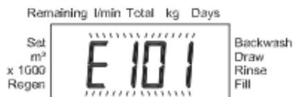
*Affichage du code d'erreur pour le type de panne détecté par le contrôle.*
