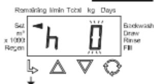
Dureté de l'eau de service (PPM) - Si un mitigeur est installé dans la vanne, la dureté de service doit être réglée. La plage de réglage est toujours inférieure au réglage de l'étape 21. Cet écran ne s'affiche que lorsque 'RES' est sélectionné à l'étape 3S. Appuyez sur NEXT pour passer à l'étape 41. Appuyez sur REGEN pour revenir à l'étape précédente.
