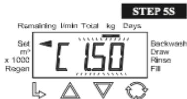
**ÉTAPE 5S :** Capacité ionique - Utilisez HAUT ou BAS pour sélectionner la capacité ionique (kg de CaCO<sub>2</sub>). Cet affichage apparaît si l'étape 4S est réglée sur RES. Si DELY ou ON 0 est sélectionné à l'étape 3S, la capacité volumique peut être réglée de 0,02 m<sup>3</sup> à 5700 m<sup>3</sup>.
