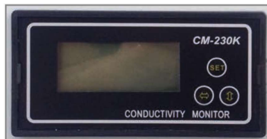
Panel de control de la conductividad y temperatura.
