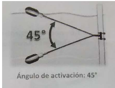
Instalación boya para activación de la señal.
