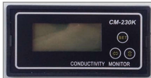
Panneau de contrôle de la conductivité et de la température.
