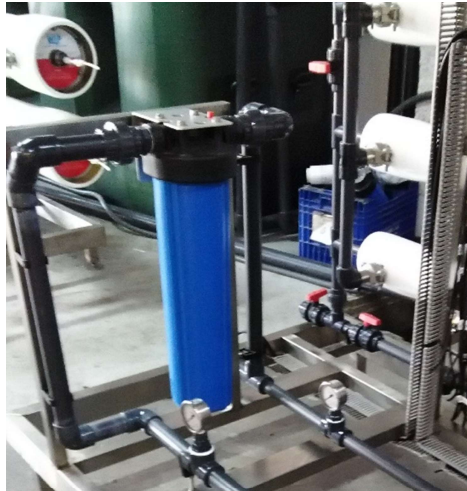
Image de filtre cartouche BIG de 20". Modèles standard.
